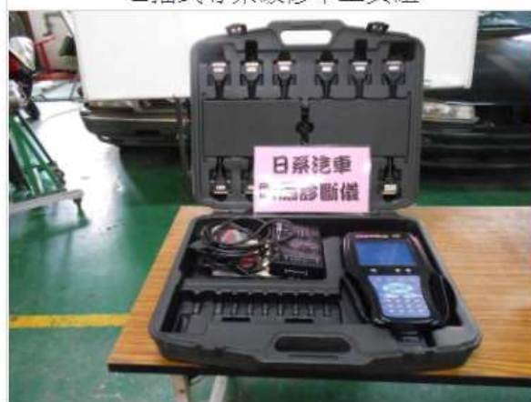
日式汽車專用電腦診斷儀器(V70)
