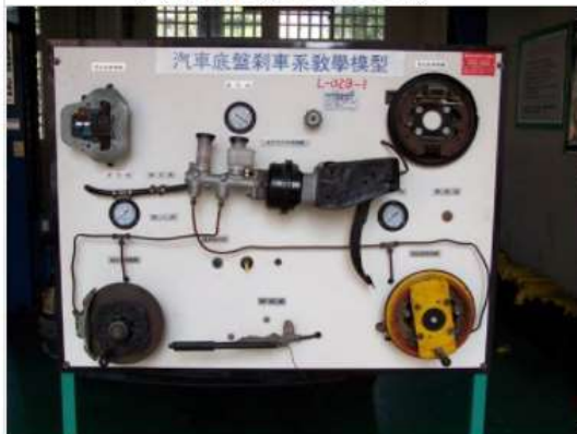
底盤系統教學-煞車系統示教板
