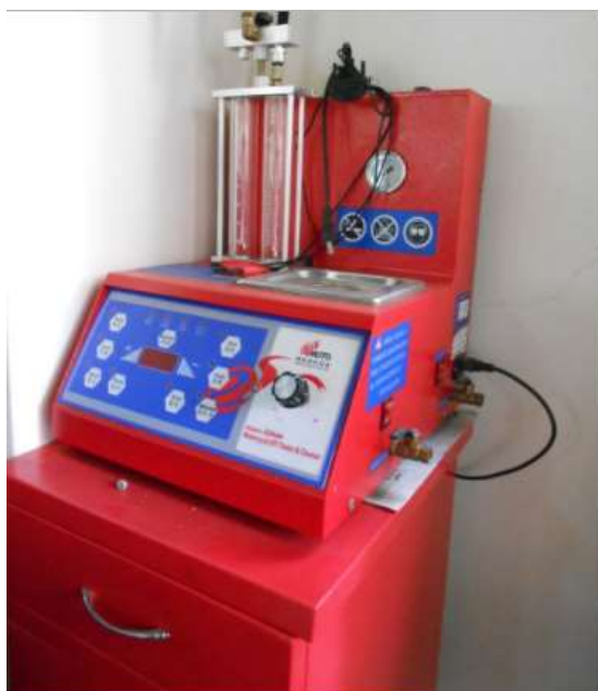
專業級汽、機車專用噴油嘴清洗機
