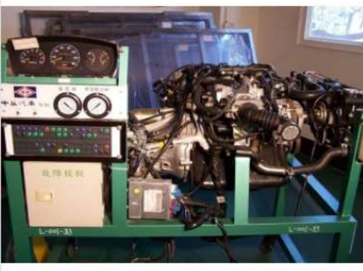
噴射引擎檢修專用--故障模擬器
