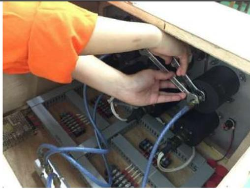
3. 拆除後方管路後，選擇適當螺絲起子再拆除前方儀表四顆。
