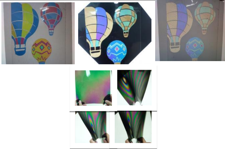
在透明塑材上的非破壞光彈性檢測應用
