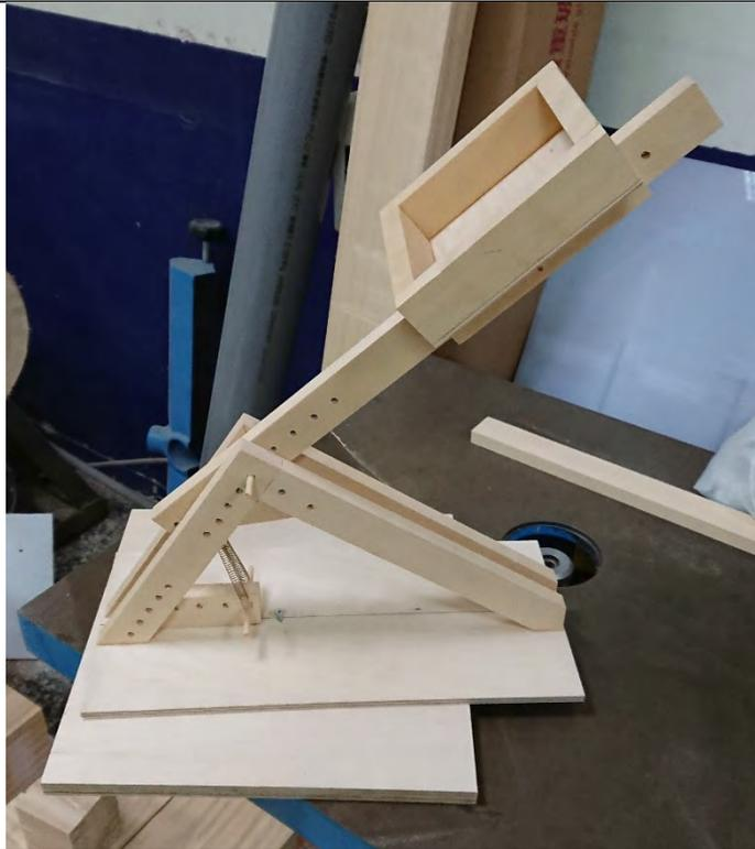
測試一下投石機的投擲臂、彈簧、置物盒在不同位置時，拋出的沙包會呈現什麼樣的飛行軌跡。
