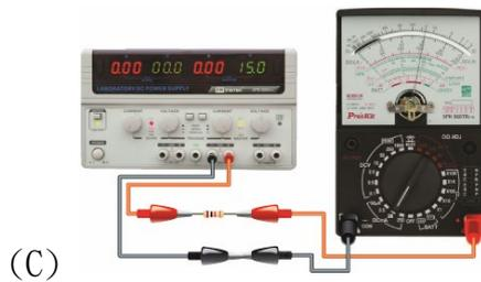
( ) 2. 圖示測量色碼電阻值其操作順序 (A) 2143 (B) 2314 (C) 1234 (D) 1243
