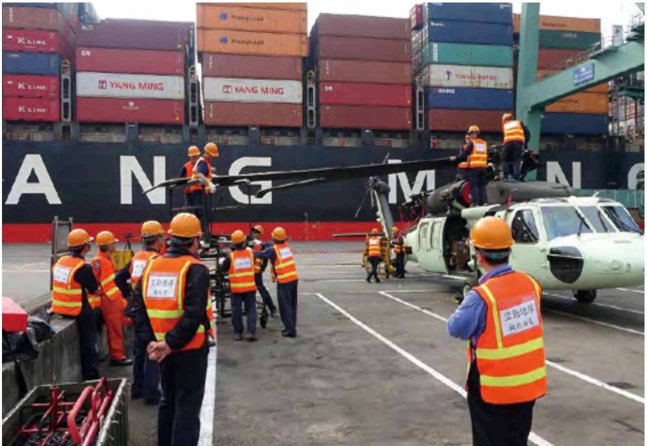
▲ 高雄港碼頭接收黑鷹機執行主旋翼展翼組裝作業。
