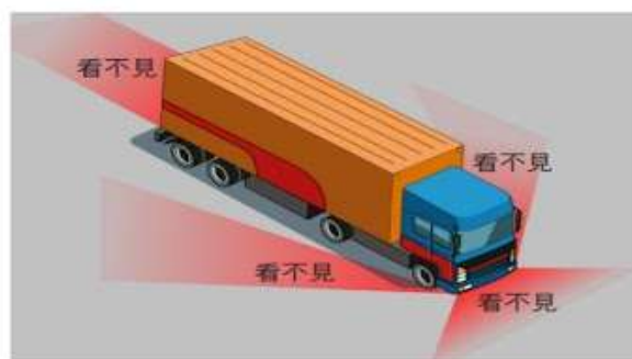
大型車駕駛的視野死角 (圖二)
