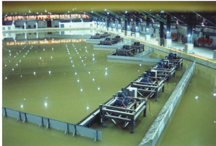
大型平面水槽（長×寬×深= 150×60×1.5m，可同步連線 10 台造波機）
