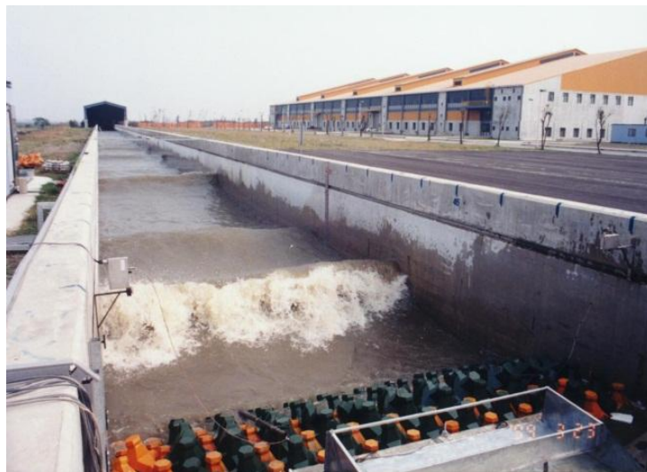
大型斷面水槽（長×寬×深 = 300×5×5m，不規則波可達 1.0 公尺）
