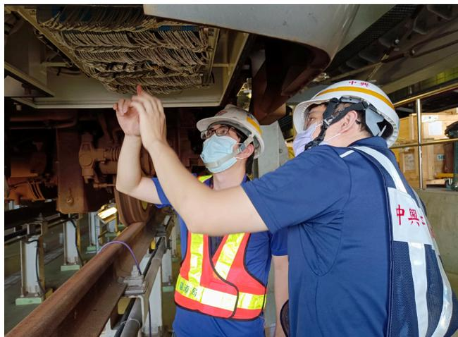
▲ 號誌系統車載設備檢視作業。(左)
