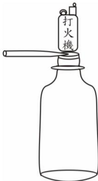
圖二、用打火機壓扁(封住)管口
