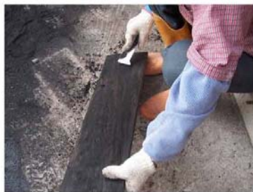
B. 碳化後將表面進行刮除處理。
