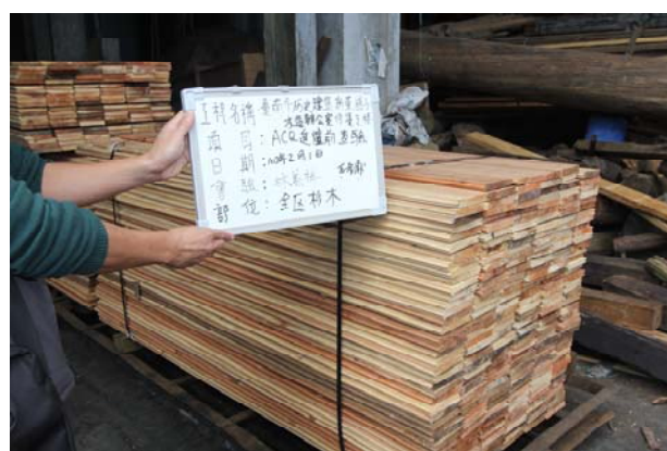
照片4-4-2 全區杉木採 ACQ 防蟲防腐處理。
