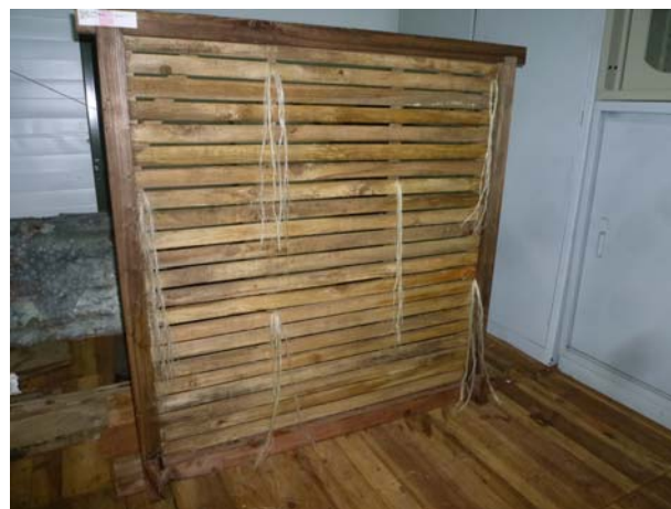
照片4-4-22 木摺灰泥牆樣品，做為鄉土教學使用。
