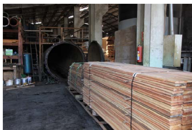
照片4-4-4 全區杉木採 ACQ 防蟲防腐處理施作情形。
