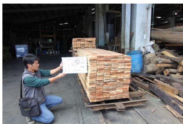
照片4-4-1 本案杉木木料進行 ACQ 進爐場驗情形。
