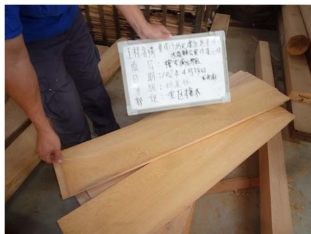
照片3-3-96 新料台檜雨淋板廠驗情形 (2)。
