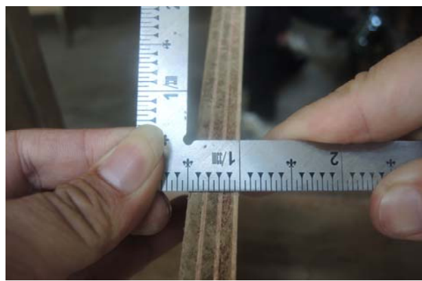
照片3-6-24 5分防水結構合板材料進場。
