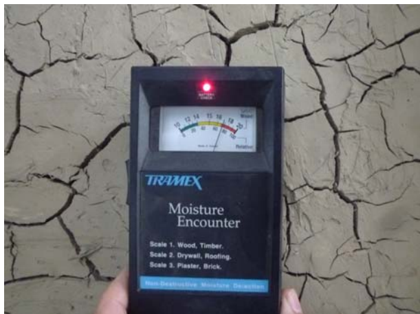
照片3-3-74 中塗泥土層乾燥度測量。
