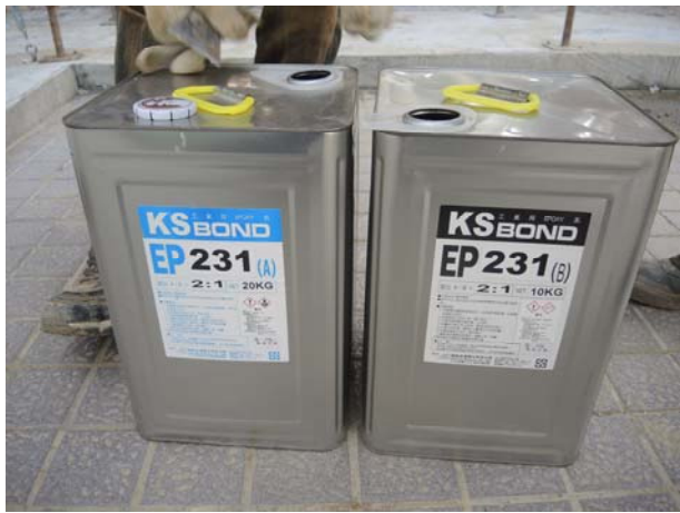
照片3-6-1 磚牆裂縫補強用 EPOXY。
