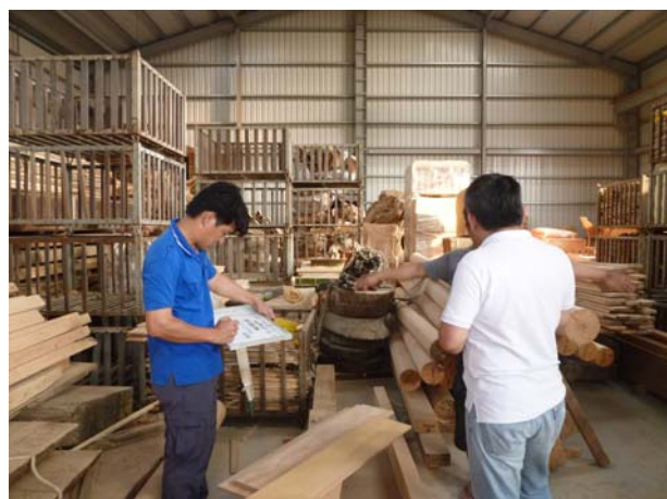
照片3-3-95 新料台檜雨淋板廠驗情形 (1)。
