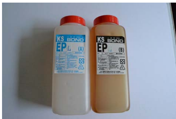
照片3-4-24 使用環氧樹脂材質做為木料粘著劑。 EPOXY 主劑 A (左)、硬化劑 B (右)。
