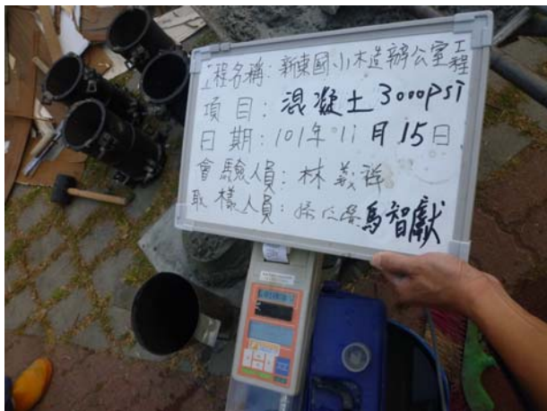
照片3-1-40 混凝土灌漿前進行氯離子試驗。
