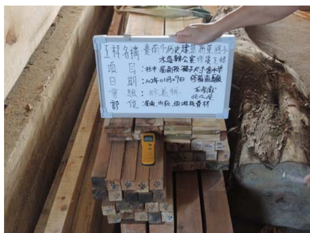
照片3-4-15 木料含水率查驗情形。
