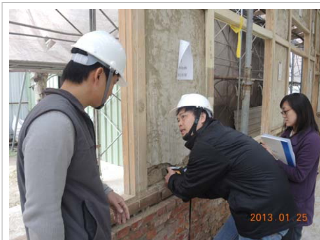
照片3-3-43 以科學儀器進行原牆體配比分析。結果詳見第四章說明。
