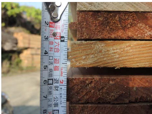
照片3-4-13 屋面板厚度尺寸確認。
