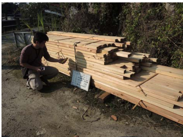
照片3-4-11 新作木料進行廠驗驗料情形，本案木料為嘉義明吉木業所出產。
