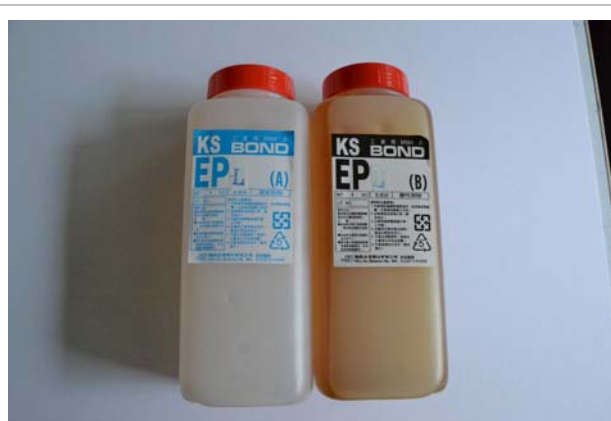
照片5-1-1 EPOXY 主劑 A（左）、硬化劑 B（右）。
