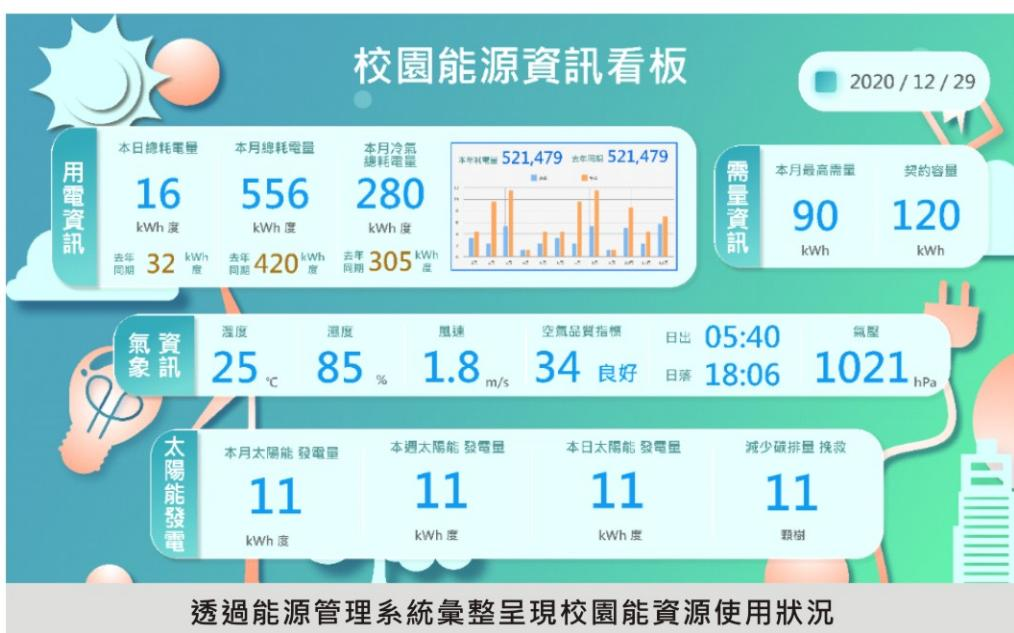
建築設備如具有能源監控管理功能，一般大約可節省電力開銷15~25%左右。節能管理策略之擬定與導入，為能否真正落實節約能源效益之關鍵所在。根據建築能源管理節能手冊之實際案例，以系統化之方式分析了建築物中央空調冰水主機側、冰水泵送側、及空氣側設備智慧型運轉策略之建立方式，經由空調改善工程之實際施工驗證，實際獲得平均約30%之節約能源效益，效果極為顯著。能源管理系統具備許多功能，透過節能管理系統雲端控制平台連結數位電表，可以進行用電資料收集，即時瞭解校園用電情形。亦可定期進行電力需量監測與控制管理，尋求合理契約容量，避免衍生非契約電費和適時調整契約容量以節省開銷。
