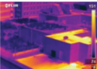
透過熱顯像儀量測可以發現，相較於裸露區域，綠化處可更有效避免結構物(屋頂)蓄熱
