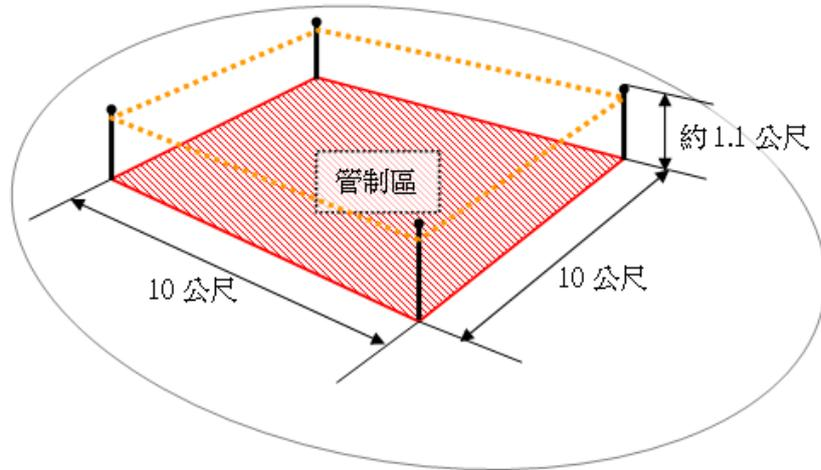
圖三 滯空飛行管制區大小示意圖
