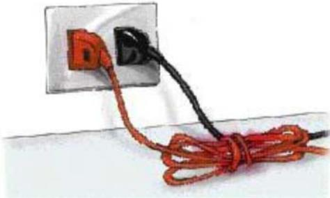
五、單一插座僅可使用一條延長線，延長線應在容許負載容量下使用，且延長線上應具過載自動斷電保護裝置或保險絲安全裝置，並不得再並接或續接其他延長線。
