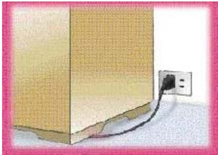
四、使用延長線時，應注意不可將其網綁、繞圈；由於電線經網綁、繞圈後，熱量很難流通，因此溫度升高而將塑膠融解，造成銅線短路著火。
