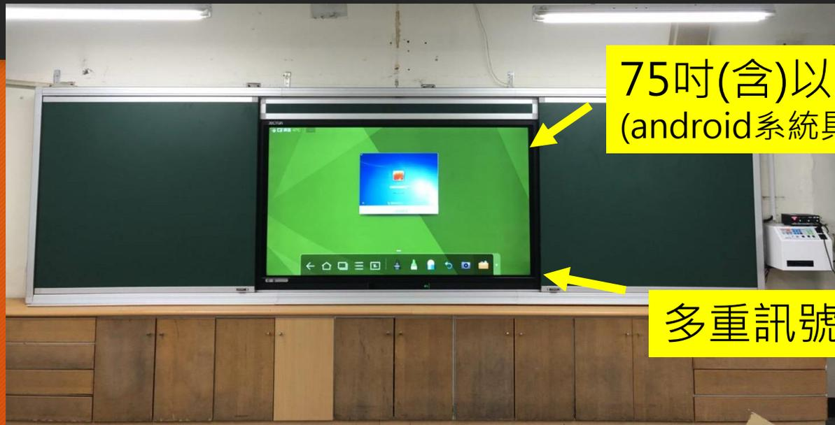
75吋(含)以上4K觸控液晶顯示器
